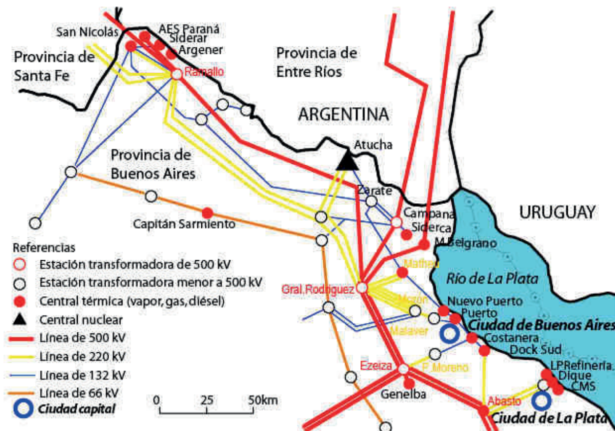
Plano N° 2 Esquema geográfico de líneas de alta tensión y centrales eléctricas metropolitanas. A partir de información de CAMMESA 2009.
